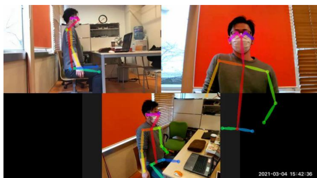
図2 OpenPose を用いた座位姿勢解析の予備実験の様子
